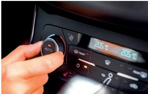
Bei manchen Modellen kann man selbst prüfen, ob die Anlage noch ausreichend Kühlmittel besitzt. In der Gebrauchsanweisung steht dann, wo ein Schauglas unter der Motorhaube zu finden ist. Bei zu geringem Füllstand sollte alsbald die Werkstatt korrigierend eingreifen. „Eine Inspektion der Klimaanlage schlägt mit ungefähr 70 Euro zu Buche“, schildert Bausch seine Erfahrungen. Von Billigangeboten, vielfach zum Frühsommer hin beworben, hält der Fachmann wenig: „Da wird oftmals nur der Druck geprüft.“
